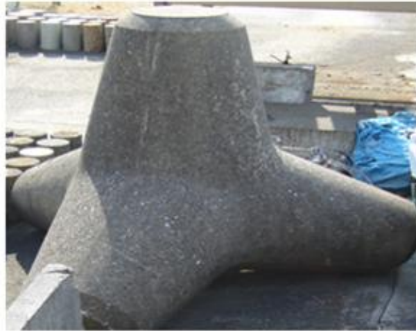
Photo 3. Un hexapode (photo SY B. A, Yokohama, laboratoire PARI, 2011)
